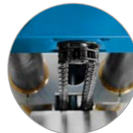
2-Säulen-Führungsprinzip mit Kettenantrieb
