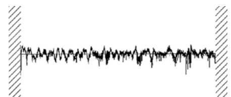
Oberfläche Superfinishen R_a = 0,051
